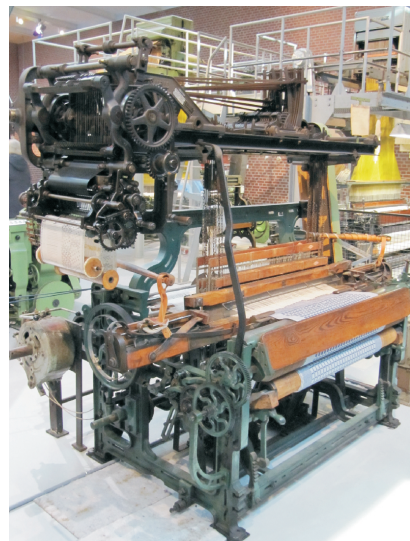
Figuur 1.3 Jacquard-weefgetouw, begin 19e eeuw. Het weefpatroon wordt door een ponsband gestuurd. (Museum Twentse Welle)
