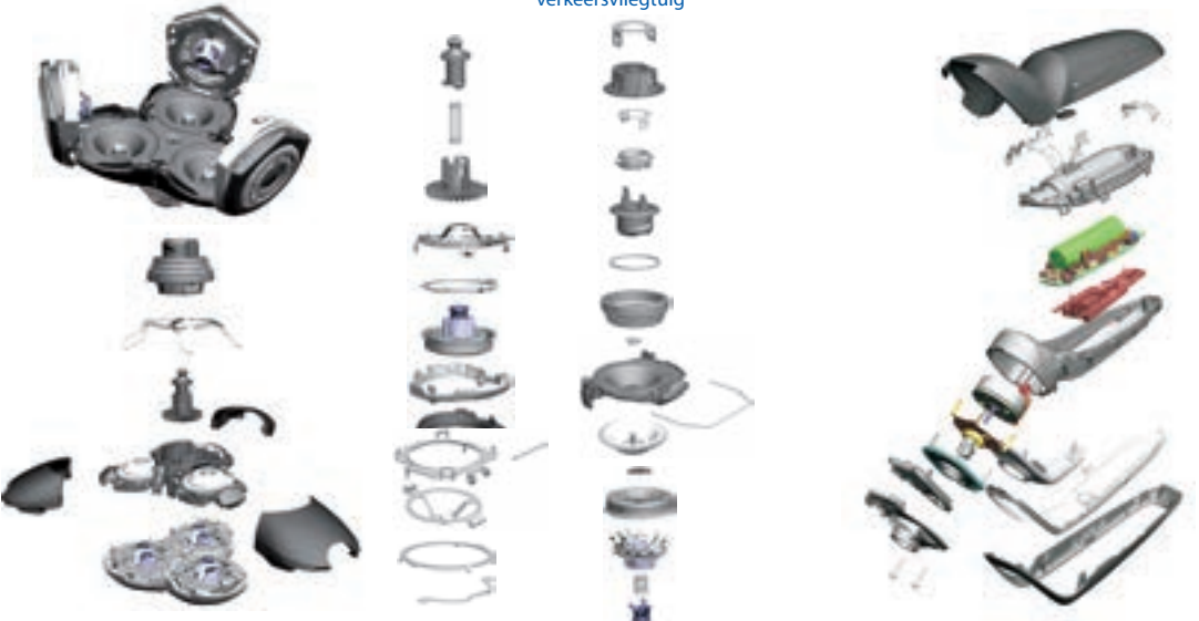
Figuur 1.10 Gedeeltelijke exploded view van het Philips-scheerapparaat
