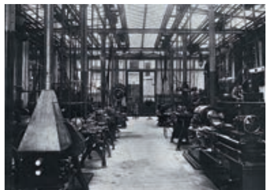
Figuur 1.2 Centrale werkplaats van de Technische Hogeschool Delft omstreeks 1938. De machines werden oorspronkelijk aangedreven door een stoommachine via aandrijfassen en riemschijven
