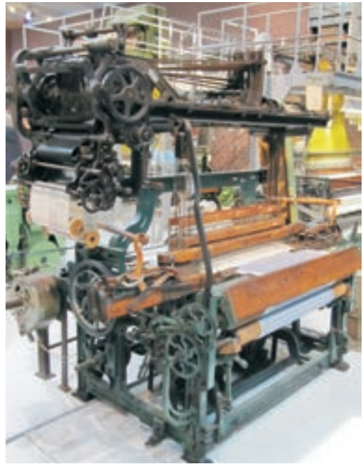
Figuur 1.3 Jacquard-weefgetouw, begin 19e eeuw. Het weefpatroon wordt door een ponsband gestuurd. (Museum Twentse Welle)
