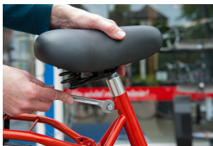
Bout losmaken met een steeksleutel.
