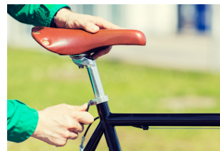
Bout losmaken met een imbussleutel.
