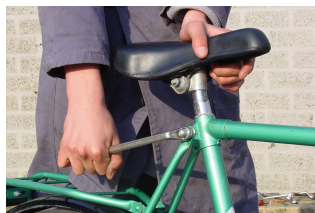
Bout losmaken met een ringsleutel.
