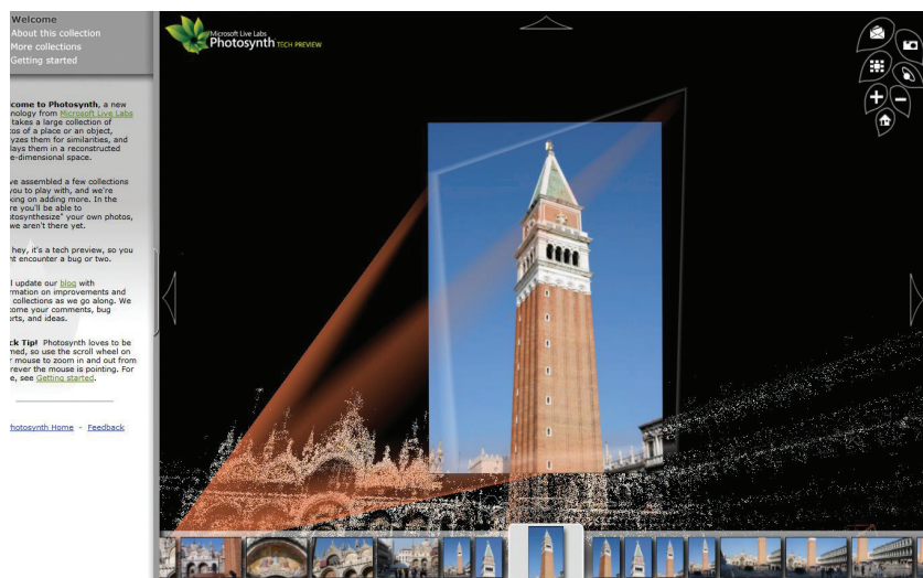
Figuur 3 • Photosynth. Uit vele foto's die uit verschillende hoeken zijn genomen wordt een driedimensionale weergave gemaakt van een gebouw of object.
